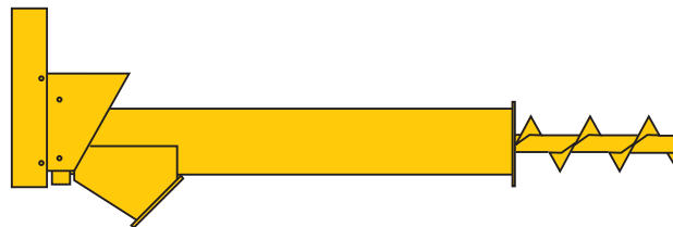
Testata con scarico tondo a 45° senza trasmissione. Round unload 45° (angle) head in/out drive. Kopf mit runder Entladung ohne Antrieb 45°. Tête avec décharge ronde à 45° sans transmission. Cabeza con descarga redonda a 45° sin transmisión.
