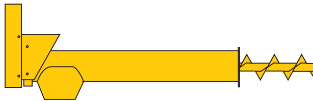
Testata con scarico tondo a 90°. 90° round unload angle head. Kopf mit runder Entladung 90°. Tête avec évacuation à 90° ronde. Cabezal con descarga redonda a 90°.
