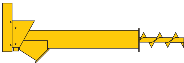
Testata con scarico quadrato a 45°. 45° square unload angle head. Kopf mit viereckiger Entladung 45°. Tête avec évacuation à 45° carrée. Cabezal con descarga cuadrada a 45°.
